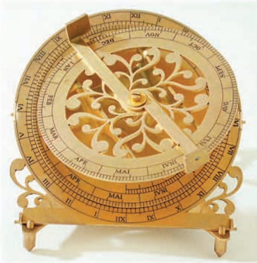
Büyükük: 10 x 10 cm. Pirinç, hâkkedilmiş. Eğim ayarlanabilir, nişangâh ve takvim dairesi eksensel döndürülebilir. (Envanter No: B 2. 11)
