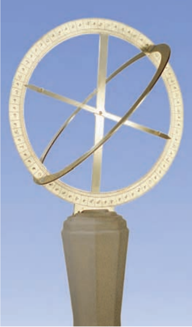
Piring, asitleme yoluyla derecelendirilmiş, merkez etrafında dönen gösterge, çap: 43 cm. Ahşap sütun, kumtaşı astarlama, mermer kaide, toplam yükseklik: 165 cm. (Envanter No: A 4.28)
