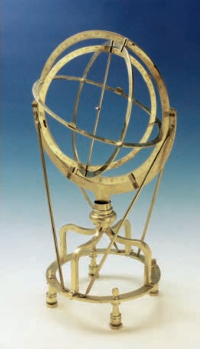
Ölçek 1:4. Çap 50 cm. Pirinç, hâkkedilmiş. Bütün halkalar her iki tarafı hâkkedilmiş derece taksimatına sahip. (Envanter No: A 4.10)
