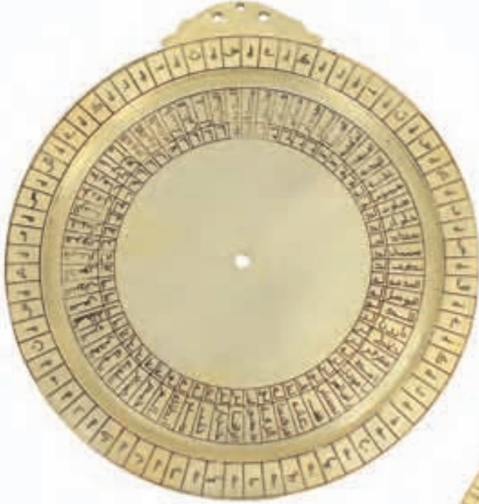
Modelimiz: Pirinç, asitle işlenmiş. Matris 130 mm çapında. Ağ, açıcı cet- veli ve iç disk yok. (Envanter No: A 2.26)
