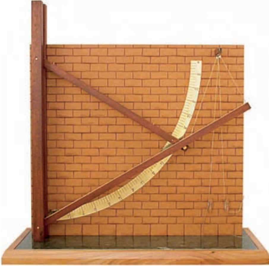
Modelimiz: Ahşap, astarlanmış; mermer kaide. Kadran piringten, asitle derecelendirilmiş; yarıçap: 40 cm. Cetveller tik ağacından iki direk arasında dikey olarak hareket edebilir. Yükseklik 64 cm. Kiriş cetveli üzerinde metrik ölçek bulunmaktadır. (Envanter No: A 4.26)
