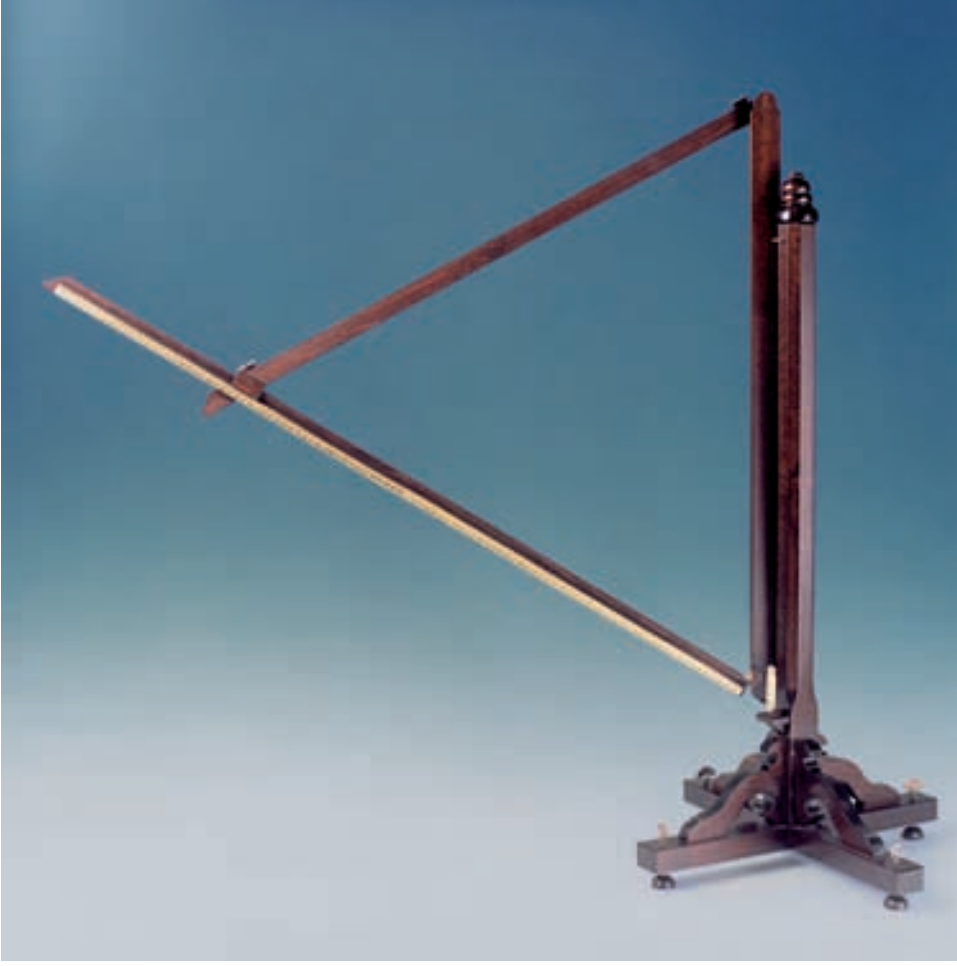
Modelimiz: Ölçek yaklaşık 1:2. Nişangâh uzunluğu 1 m. Eskitilmiş sert ağaç. Uzunluk derece taksimatlı pirinç skala. (Envanter No: A 4.06)
