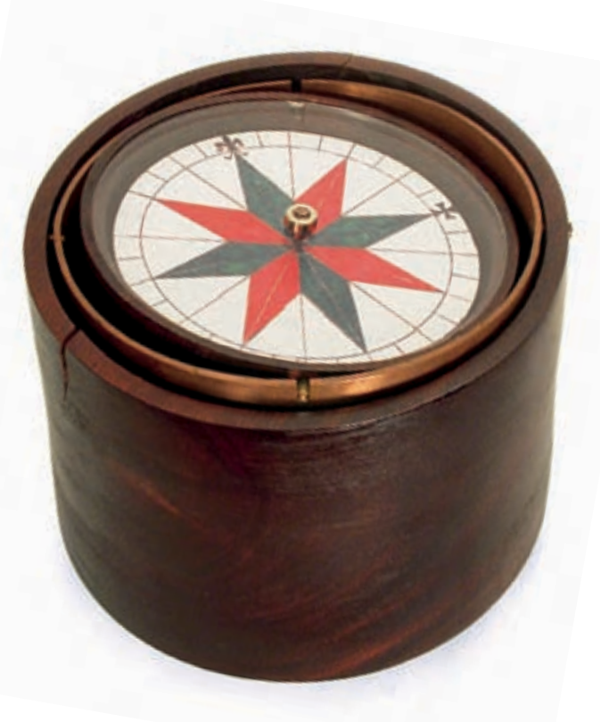
Tornalanmış silindir, sert ağaç. Çap: 24,5 cm. Yükseklik: 17 cm. «Kardano» sistemi süspansiyonu bakır halka aracılığıyla. Disk, balık formunda eğilmiş demir tel ile iki uç arasında, döndürülebilir halde yarım küre formundaki pusula mahfazasına oturtulmuştur. (Envanter No: C 1.09)
