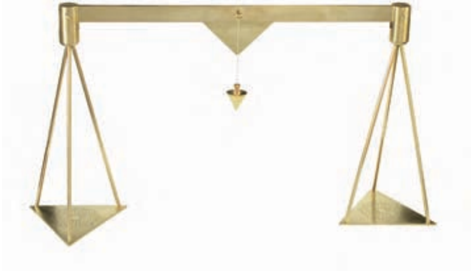
el-Marrākuşī tarafından tarif edilen ilk tesviye aleti. Modelimiz: Pirinç, en: 52 cm. (Envanter No: D 1.28)
