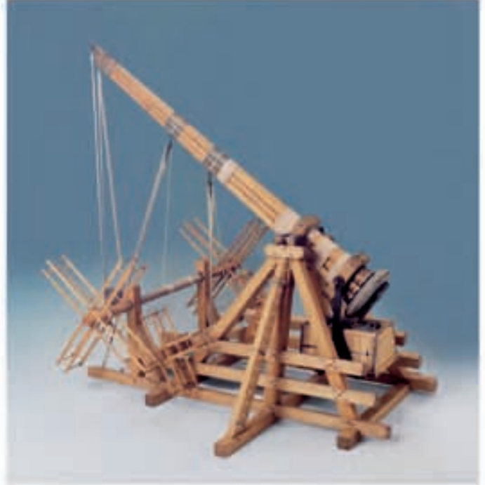
Modelimiz: Sert ağaç. Ölçek: 1:20. Fırlatma kolunun uzunluğu: 100 cm. (Envanter No: G 1.07)
