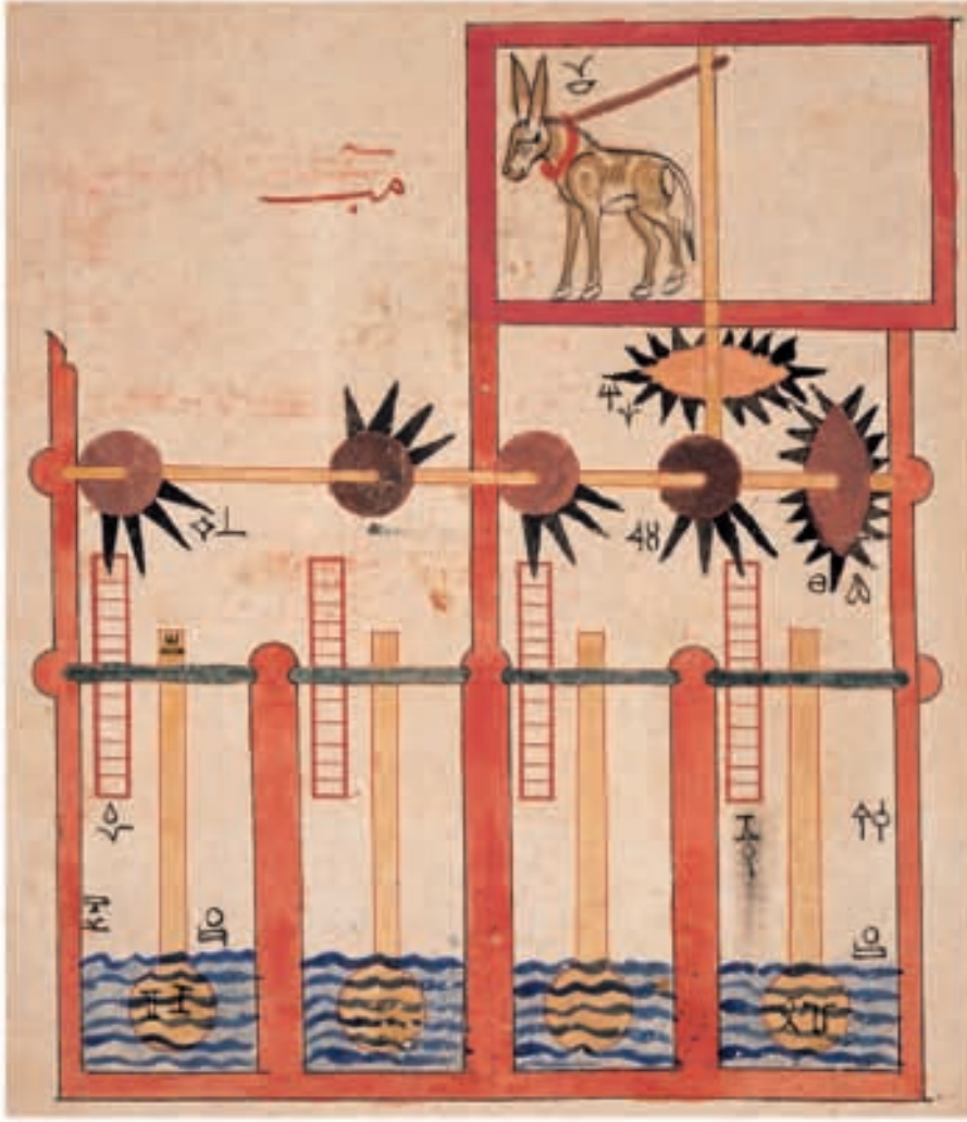
Beygirle döndürülen dolabın resmi, el-Cezerî'de, el-Cāmi' beyn el-İlm ve-l-ʿAmel en-Nāfi' fi Şināʿat el-Ḥiyel , tıpkıbasım ed. Frankfurt 2002, s. 481.
