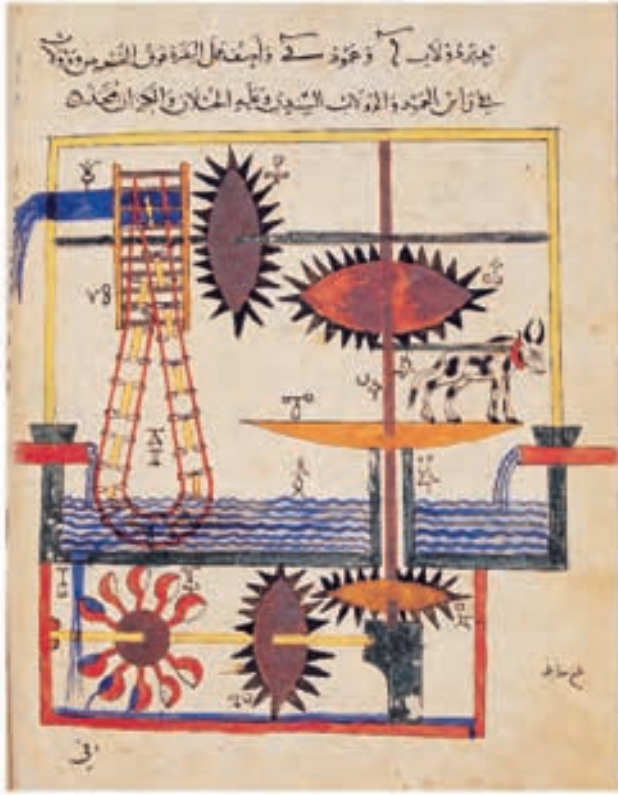
el-Cezerî'de kovalı su dolabı, el-Cāmi c beyn el- c İlm ve-l- c Amel en-Nāfi c fī Şinā c at el- c Hiyel , tıpkıbasım ed. Frankfurt 2002, s. 486.
