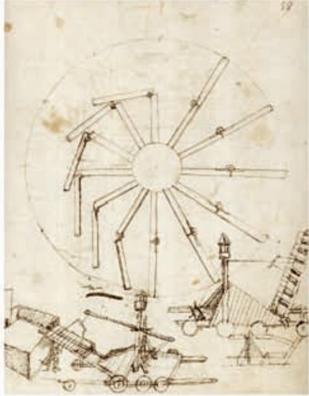
Resim, Mariano Taccola'nın not defterinden (15. yüzyılın birinci yarısı) 6 . Sayfanın alt tarafında savaş makinelerinin taslakları bulunmaktadır. Bu Perpetuum mobile, modelimizde sunulan ile şaşırtıcı bir benzerlik göstermesi nedeniyle daha eski İslami kaynakların, İslam bilimlerini Avrupa'ya taşıma işinin öncüleri için çok önemli olduğuna ilişkin bir diğer kanıttır.
